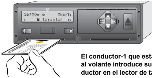
**El conductor-1 que estará efectivamente al volante introduce su tarjeta de conductor en el lector de tarjetas-1.**
